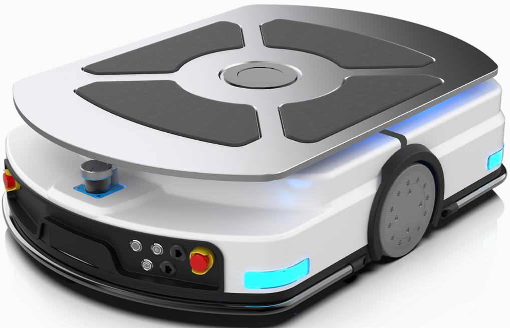
AMR 移动机器人 -TP 顶升系列，采用中置双差速轮式底盘结构，使用激光 SLAM 导航技术，实现自主导航和避障，灵活完成潜伏、背负、顶升。能够在工业环境下的生产、仓储、运输等场景中使用，实现点位到点位多种任务。
